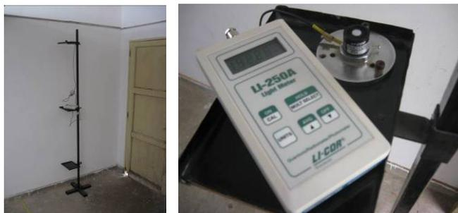
Figura 3- Equipamiento; Columna con alturas pre-fijadas y sensor fotométrico LI-210 SB.
