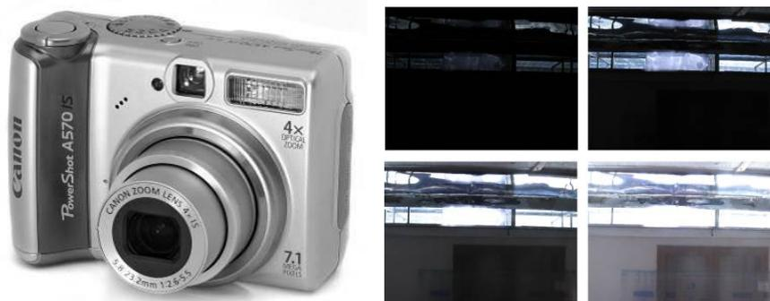
Figura 4- Izquierda, modelo de cámara utilizado; Derecha, muestra de fotografías tomadas con diferentes velocidades de obturación.
