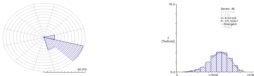
Figura 4 – Frequência de distribuição e rosa dos ventos para o Projeto MERRA, a 75 metros – parque eólico B
