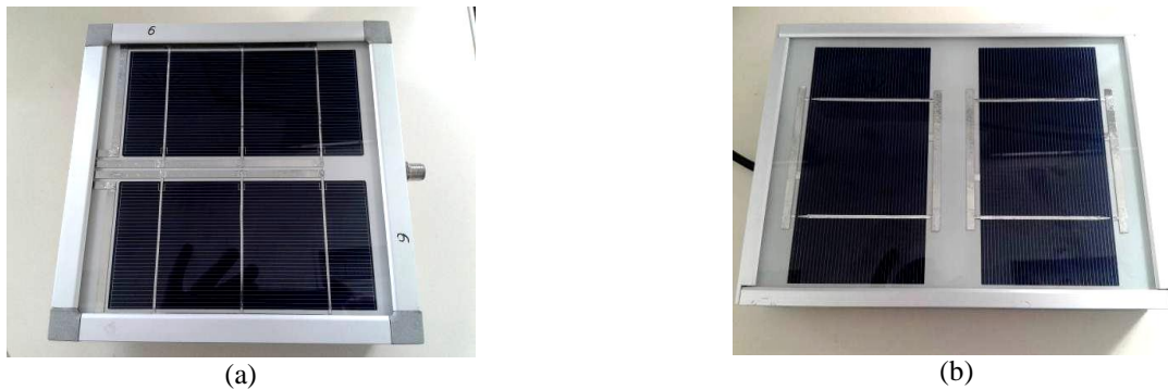
Figura 2- a) Fotografía de la celda patrón construida y calibrada por PV Evolution Labs. b) Fotografía de una celda a ser contrastada, desarrollada.
