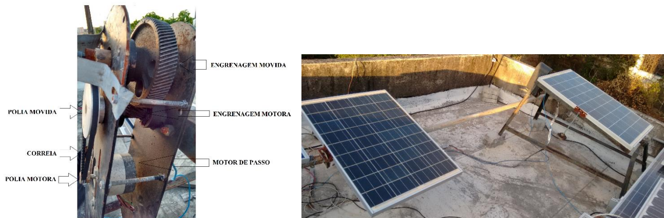
Figura 4 – (a) Motor de passo e sistema de transmissão mecânica; (b) Módulos FV utilizados.
