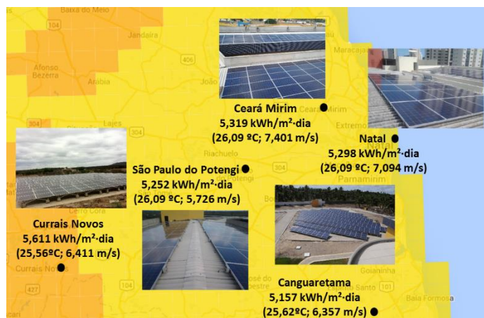
Figura 13 – Imagens e dados de irradiação, temperatura e velocidade do vento das cinco UFVs do IFRN.
