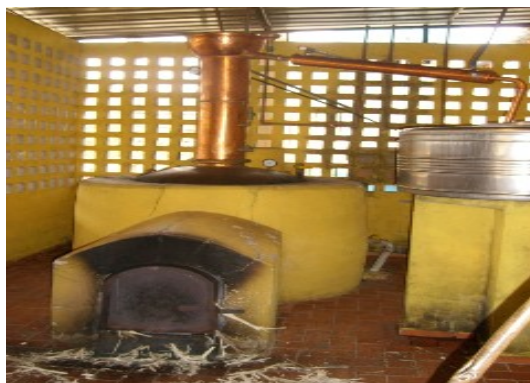
Figura 4 – Alambique simples com fornalha para queima de bagaço (Nogueira, 2008)
