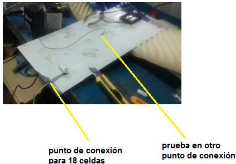
Figura 9 - Nuevos puntos de conexión del módulo
