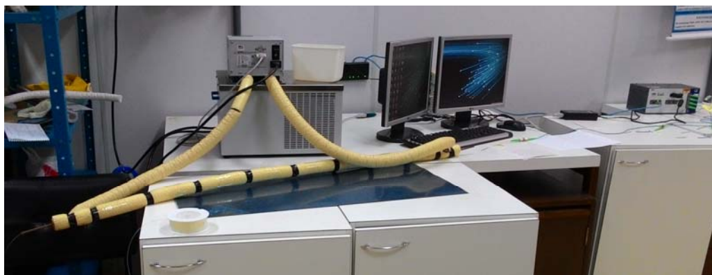
Figura 4 – Arranjo experimental do sistema de calibração dos sensores a fibra ótica.
