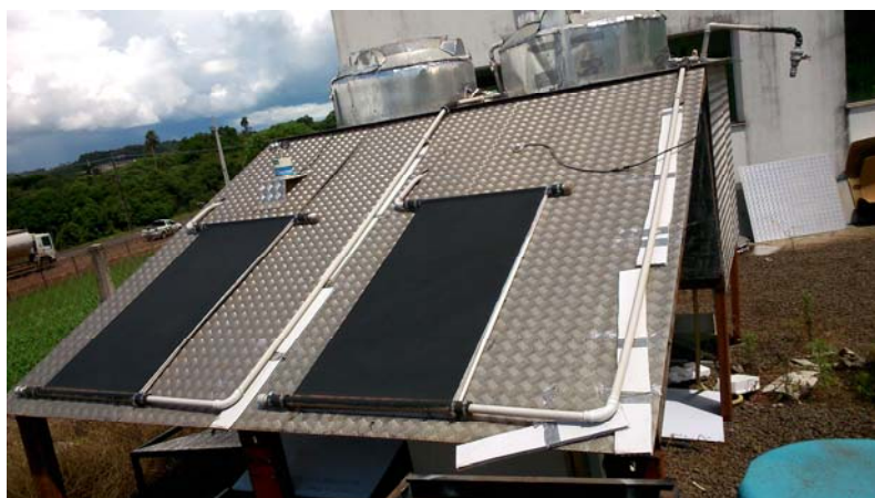
Figura 2 – Arranjo experimental de sistema de aquecimento de água, localizado na UTFPR campus Pato Branco/PR.
