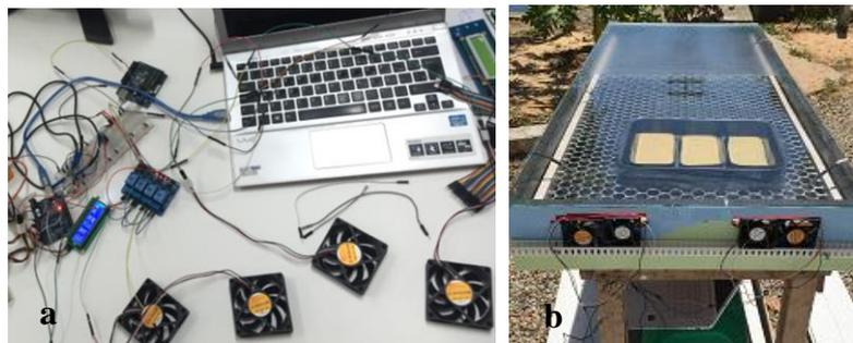
Figura 4 - Monitoramento da temperatura de secagem (a) arduino montado com os componentes eletrônicos (b) coolers instalados no secador.
