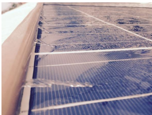
Figura 8 – Sistema de refrigeração instalado e funcionando em um conjunto de painéis fotovoltaicos.
