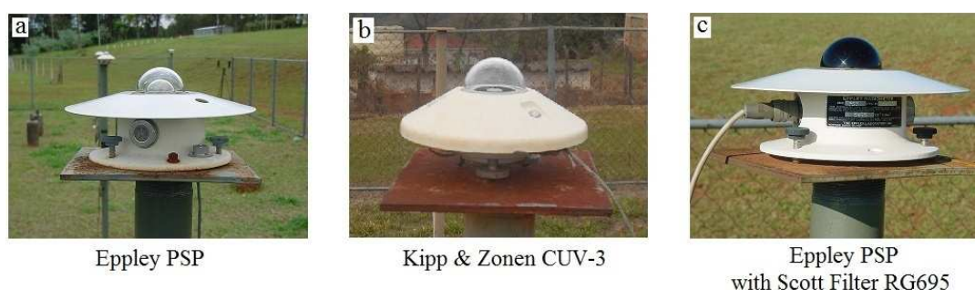
Figura 1 - (a) piranômetro PSP; (b) radiômetro CUV-3 Kipp-Zonen; (c) piranômetro PSP com cúpula seletiva.
