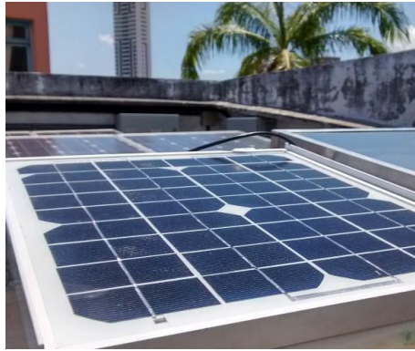
Figura 4 - Painel voltaico calibrado utilizado nos experimentos.
