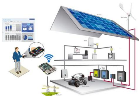
Figura 2- Sistema de Gestão de Energia Elétrica implementado em uma residência.
