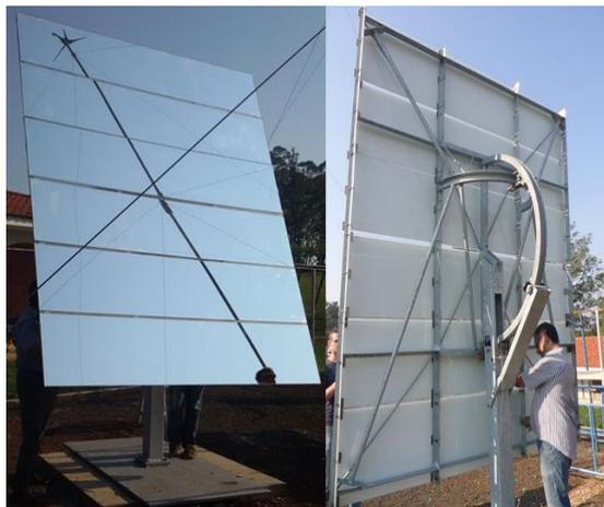
Figura 13 - Heliostato com superfície ótica composta por 6 tiras de espelho curvadas.
