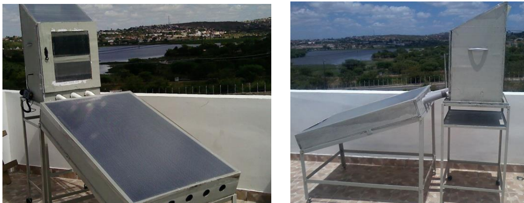
Figura 1 - Fotos do Secador Solar no solarium do LEMT/UFCG.
