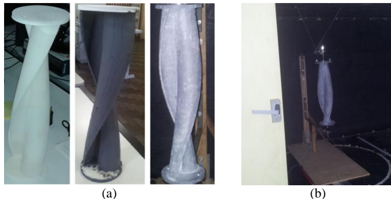
Figura 3 - Modelo turbina Savonius helicoidal com torção de 180°: (a) modelo impresso; (b) suporte.
