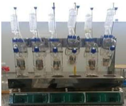
Figura 3 - Extrator tipo Soxhlet.
