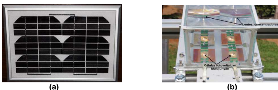
Figura 3 – (a) módulo fotovoltaico convencional e (b) módulo fotovoltaico com concentração (CPV). (Fotografado pelos autores)
