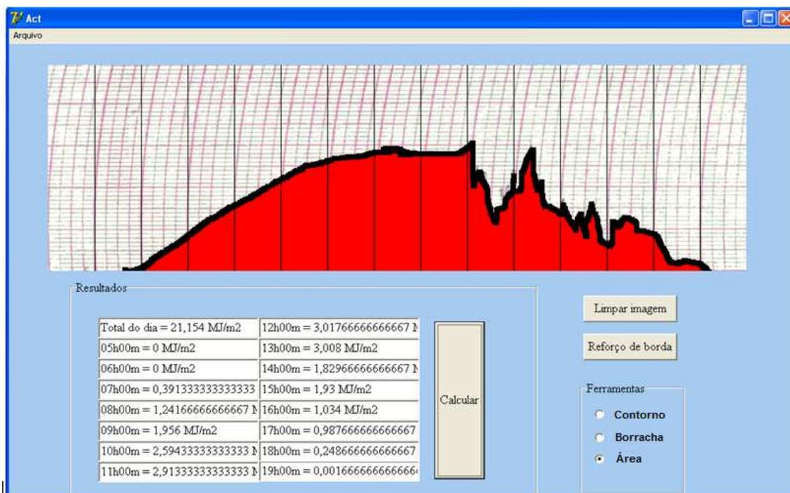
Figura 7 - Resultados horários e diário da radiação solar global incidente obtidos por meio da aplicação do Módulo Contagem.
