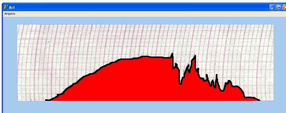
Figura 6 - Aplicação da ferramenta “área” por meio do método *floodfill* para preenchimento em vermelho da área sob a curva de interesse.
