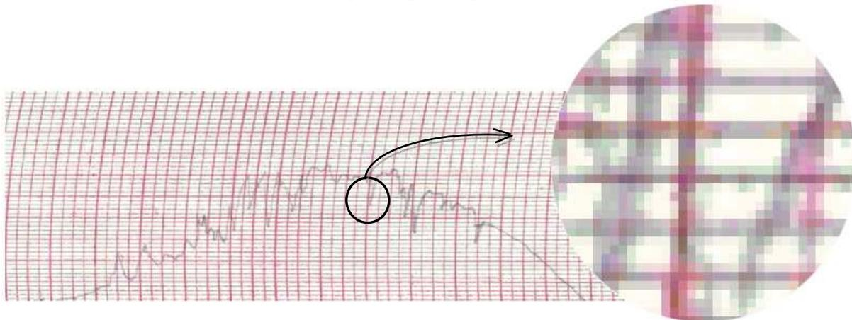
Figura 3 - Falta de uniformidade entre as tonalidades de cinza, branco e vermelho para pixels da imagem.
