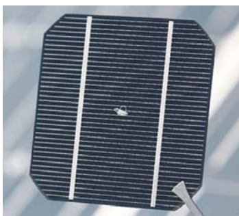
Figura 2 - Célula solar fabricada em Si-Cz, tipo n, com emissor de boro.
