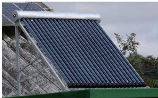
Figura 5 – Foto do coletor de tubos a vácuo ensaiado.
