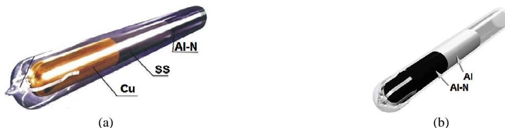
Figura 3 – (a) Camada de Al-N/SS/Cu; (b) Camada de Al-N/Al. Fonte: adaptado de apricus.com.
