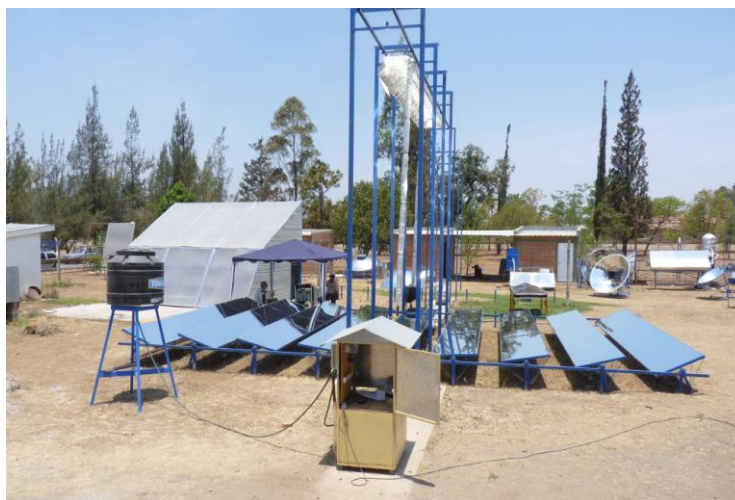
Figura 3: Prototipo de concentrador Fresnel lineal de 43 m 2
