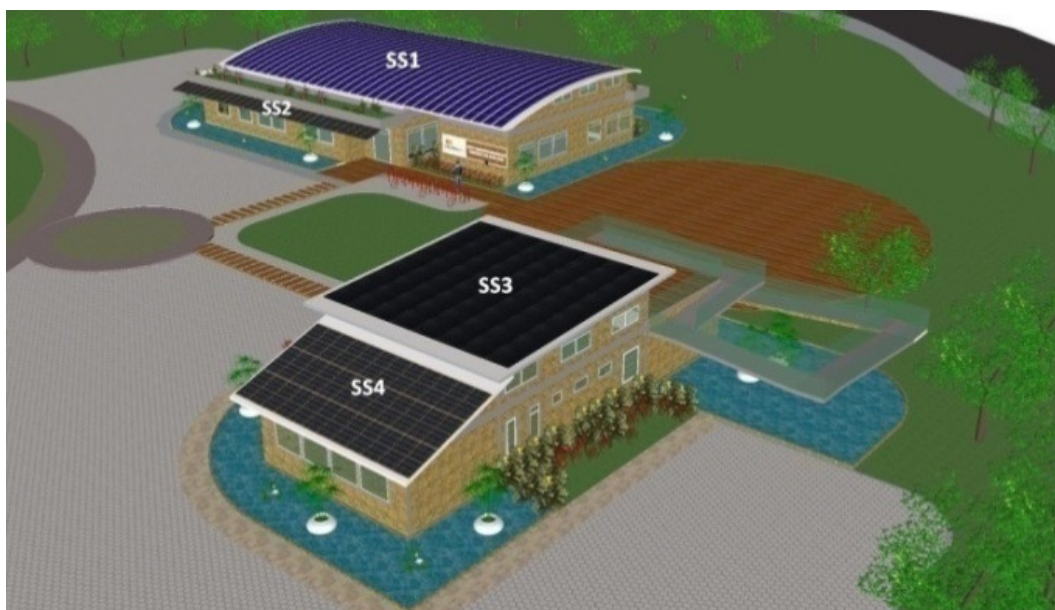
Figura 4. Localização e forma dos subsistemas fotovoltaicos instalados no Centro Integrado Multiusuário de Capacitação de Recursos Humanos e Desenvolvimento em Energia Solar Fotovoltaica.
