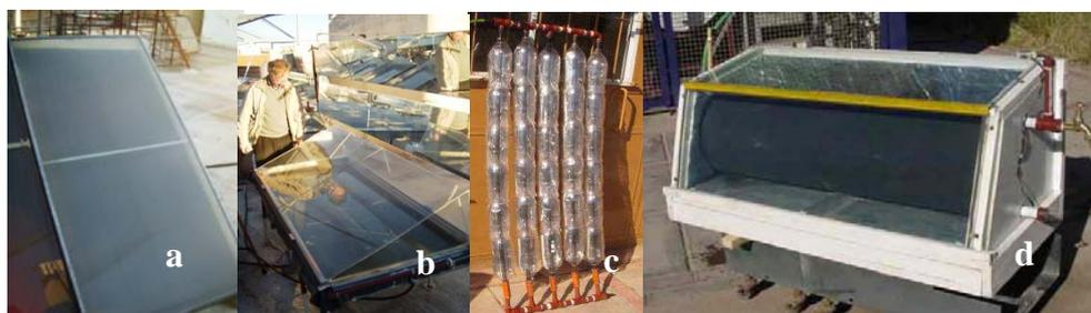
Figura 3: ejemplos de equipos para calentamiento y tratamiento de agua: a) calefón solar de Tecnosolar empresa Argentina; b- destilador solar desarrollado en la UNSL; c- colector con elementos reciclados; d- calefón tanque, ambos del CONICET.
