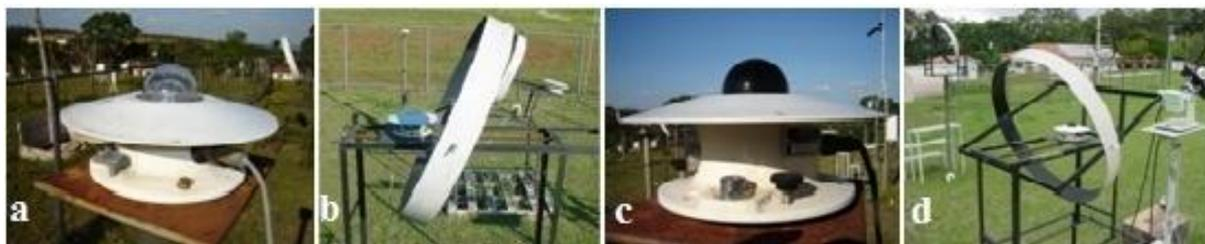
Figura 3 - Piranômetro medindo A global total; b)piranômetro com anel de sombreamento medindo a difusa; c) piranômetro medindo a IV, e d) piranômetro com anel de sombreamento medindo a difusa infravermelho.
