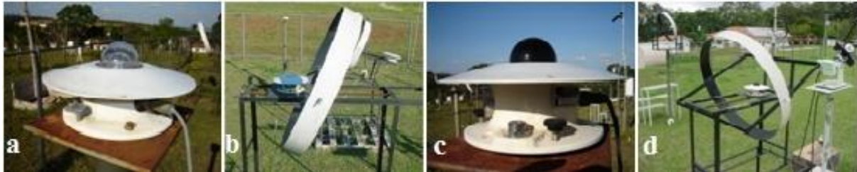
Figura 3 - piranometro medindo A global total; b) piranometro com anel de sombreamento medindo a difusa; c) piranometro medindo a IV, e d) piranometro com anel de sombreamento medindo a difusa infravermelho.
