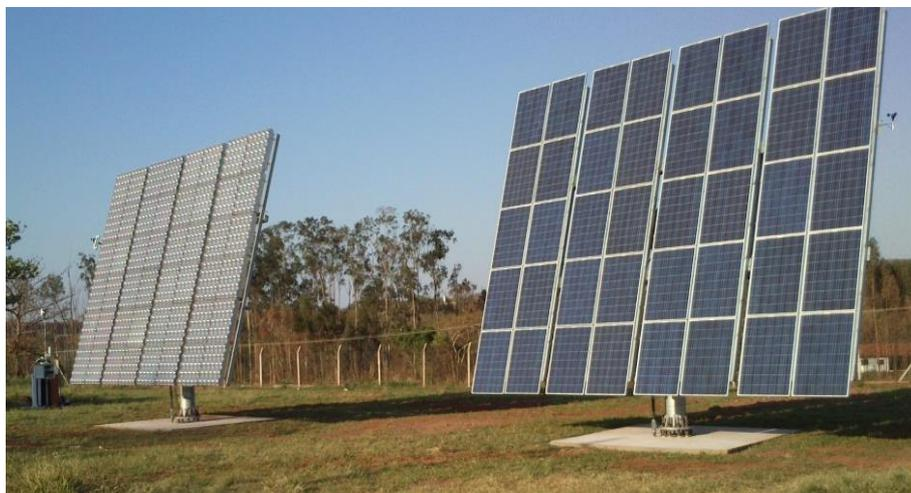
Figura 3. Sistemas com módulos de concentração (esquerda) e módulos planos (direita). Observa-se a estação solarimétrica ao fundo e à esquerda.
