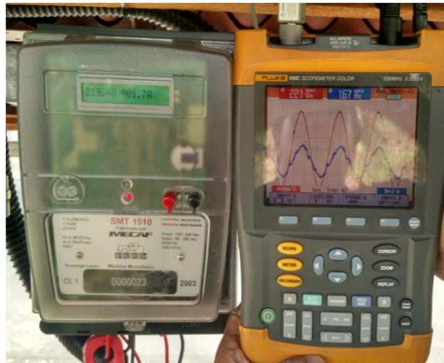
Figura 3 – Validação do valor de tensão e corrente mostrados no medidor e no osciloscópio portátil.
