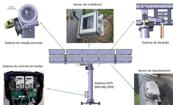
Figura 3 – Diagrama esquemático dos componentes do sistema de rastreamento implementados no gerador HCPV DEN-FAE-UFPE.
