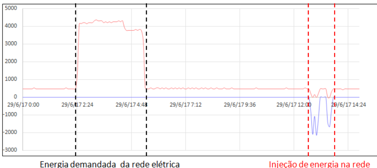
Figura 7 – Exemplo de injeção de energia na rede.
