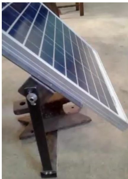
Figura 9 – Dispositivo seguidor em desenvolvimento com painel de 30 Watts (maior escala).
