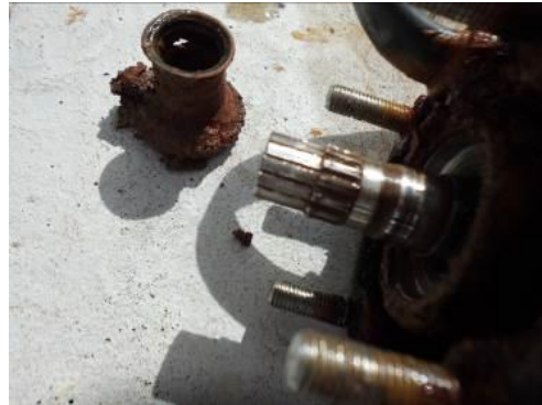
Figura 3. Detalhe da ponta do eixo desgastada.
