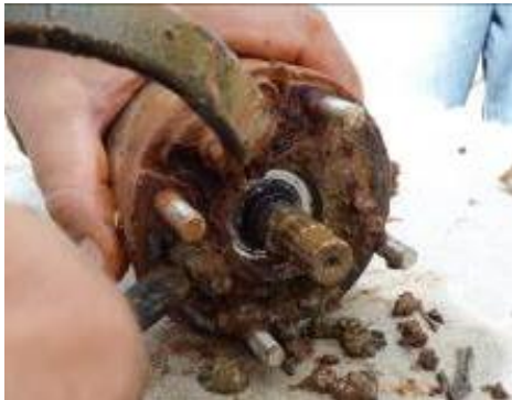
Figura 2. Retirada de sedimentos da união do motor com a bomba.
