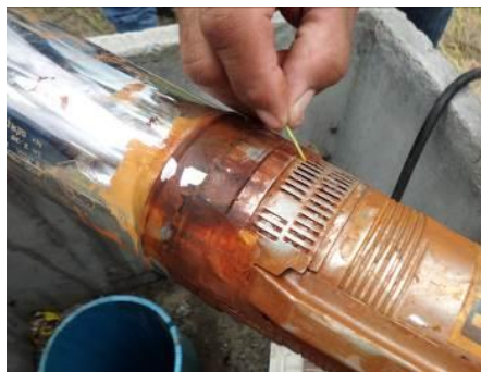
Figura 4. Motobomba de Angico Grande retirada do poço para conserto.
