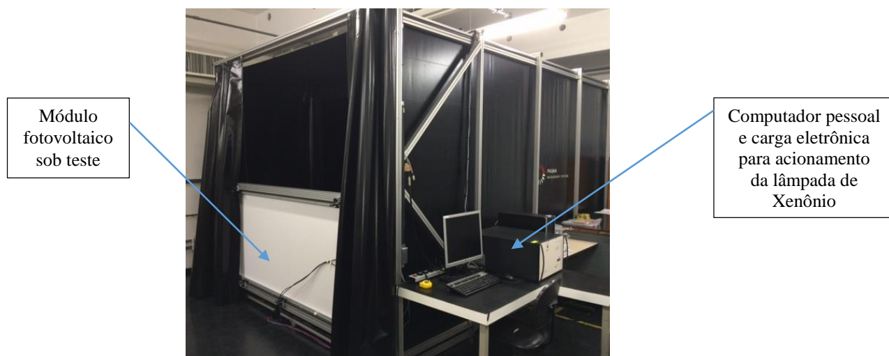
Figura 2 - Simulador solar PASAN classe A+A+A+ padrão AM 1.5 utilizado para ensaios de módulos fotovoltaicos.
