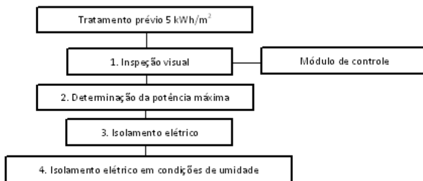
Figura 3 - Fluxograma de ensaios de módulos de Silício cristalino.
