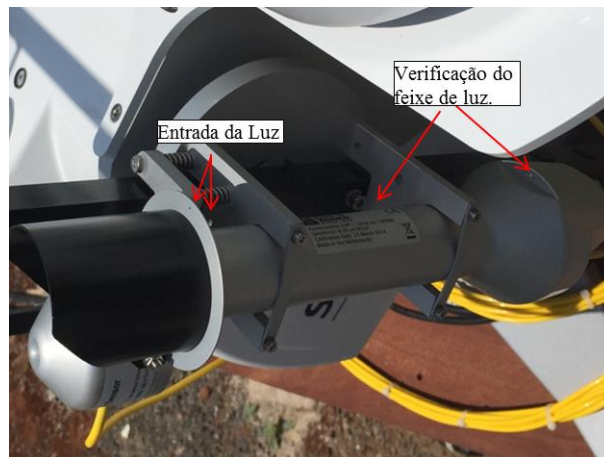
Figura 17 - Alinhamento do rastreador e do pireliômetro com a identificação das miras.
