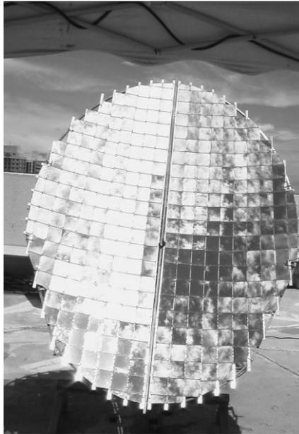
Figura 1 - Concentrador solar tipo Scheffler
