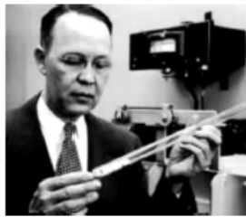
Figura 1 – Calvin Fuller prepara uma amostra de silício dopado com arsênio para colocá-la em um forno de difusão de modo a criar uma junção p-n.
