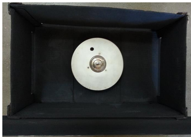
Figura 4 - Suporte do instrumento de medida e das placas de policarbonato
