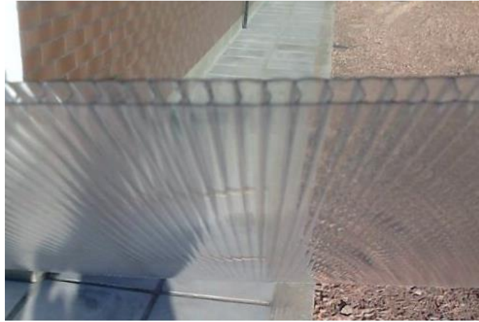
Figura 2 - Policarbonato alveolar claro de 6 mm de espessura
