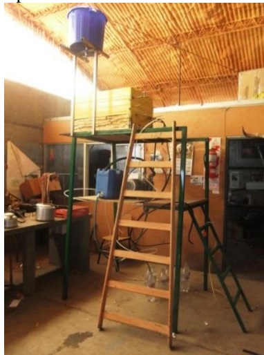
Figura 5 - Destilador instalado en el laboratorio para realizar los ensayos
