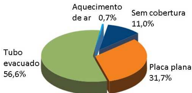
Figura 1 – Distribuição da capacidade total instalada em operação por tipo de coletor em 2010.
