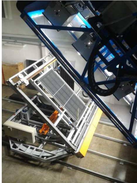
Figura 2 - Simulador solar do IPT para ensaio de coletores solares.
