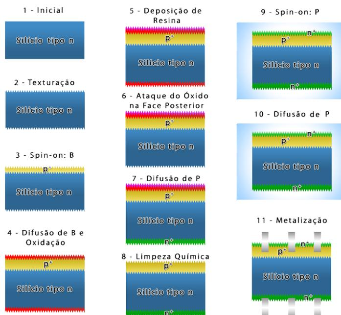
Figura 1 - Processo para a fabricação de células solares com a estrutura (n)p<sup>+</sup>nn<sup>+</sup>.
