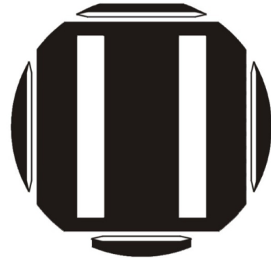
Figura 3 - Desenho da máscara utilizada para depositar a pasta de Al em toda a superfície com exceção das barras coletoras de 10 mm de largura.
