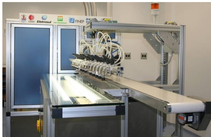
Figura 2 - Equipamento usado para a soldagem das tiras de células solares.
