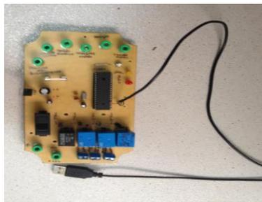
Figura 6- Circuito de acionamento.
