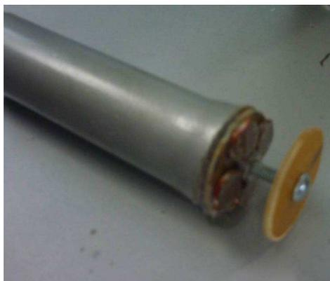
Figura 7- Sensor de posição composto por quatro LDRs.
