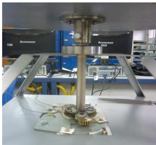
Figura 13: Acoplamento do eixo de rotação.
