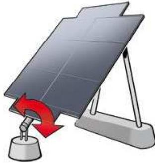
Figura 2- Rastreador Solar do tipo polar de eixo simples. Adaptado de Solar Choice (2010).
