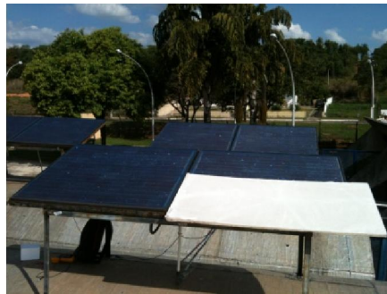
Figura 6 - Ilustração de duas strings de um módulo coberta para sombreamento
