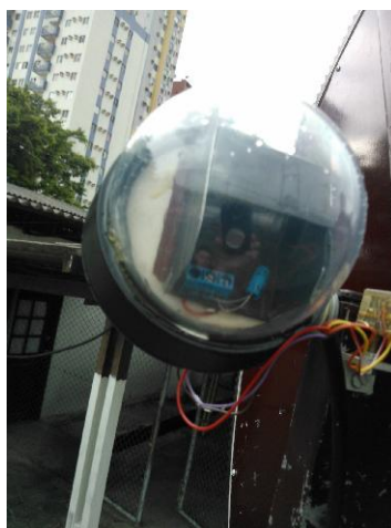
Figura 7 – Montagem do módulo de sensores LDR
