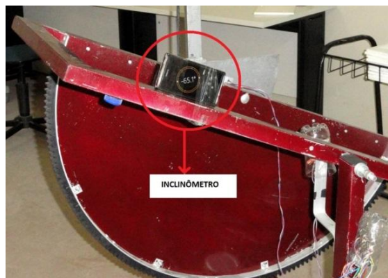
Figura 3 – Inclinômetro acoplado a estrutura
