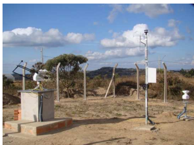
Figura 2 - Estação solarimétrica utilizada para validação dos modelos.
