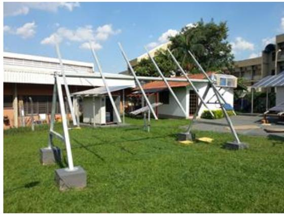
Figura 11 - Estrutura metálica do protótipo do seguidor solar.
