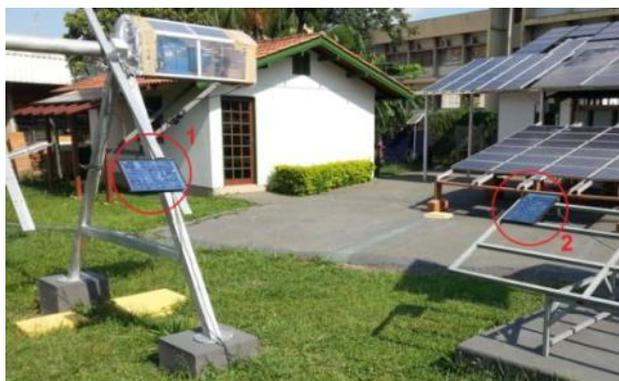
Figura 17 - Localização dos módulos de referência: 1 – plano móvel e 2 – plano fixo.
