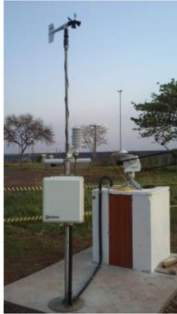
Figura 6 - Estação solarimétrica.
