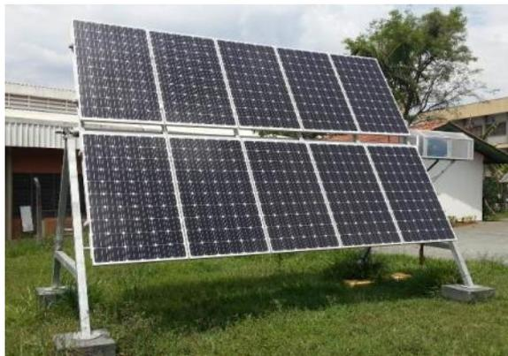
Figura 1 - Protótipo de seguidor solar desenvolvido no escopo do projeto “Seguidores solares para sistemas fotovoltaicos conectados à rede: Sistemas com e sem concentração”.
