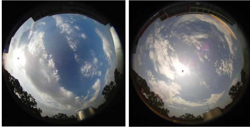
Figura 4 - Imagens do céu nas quais os círculos indicam a posição calculada do sol. Céu de Folsom-CA em horários diferentes. (fonte: Coimbra Energy Group )
